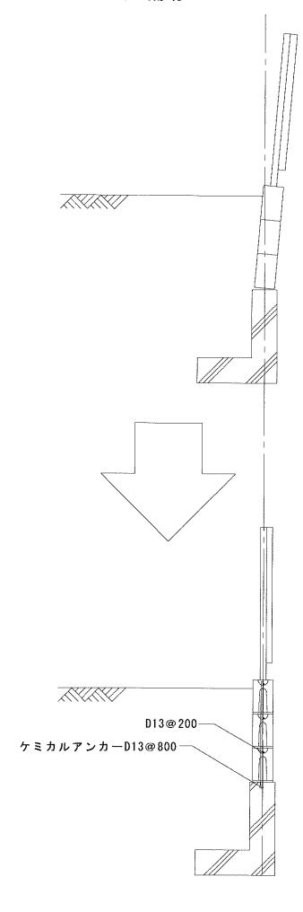
現 況土留ブロック3段傾き補 修基礎コンクリートは現状のまま上部ブロック+フェンス撤去
