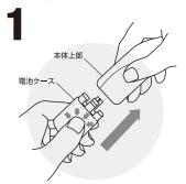
電池ケースの突起部分(下側)を親指で強く押えながら本体上部を取り外してください。
