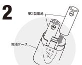
単3乾電池を⊕の表示どおり正しく入れてください。そのあと本体上部をしっかりと取り付けてください。電池を入れる向きが逆の場合、正常に作動しません。電池ケースの取り付け向きもご確認ください。
